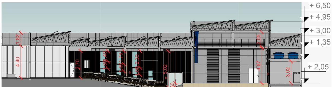
Figura 17: Corte longitudinal do Auditório.
