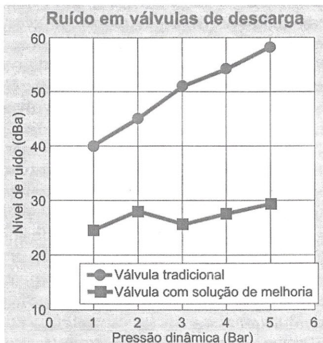
Figura 02 - Ruído em válvulas de descarga
