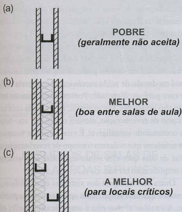
Figura 6 – Paredes de placas de gesso.
