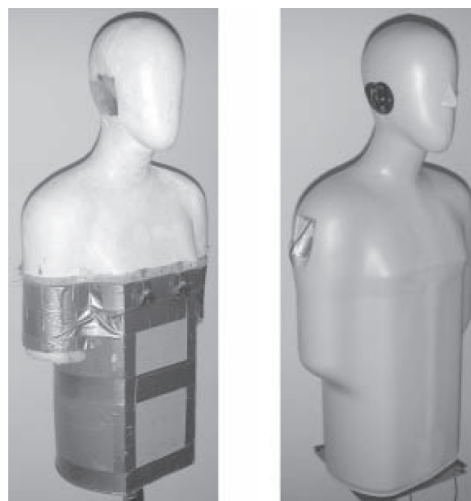
Figura 29: O protótipo final feito de madeira e gesso (esquerda) e o modelo final (direita) do manequim Valdemar da Universidade de Aalborg, Dinamarca, Fonte: [21].
