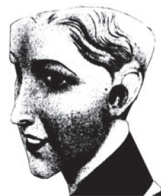
Figura 5: O manequim feminino de De Boer e Vermeulen, no qual os microfones ficavam “dentro” dos pavilhões auditivos. Fonte: [30]
