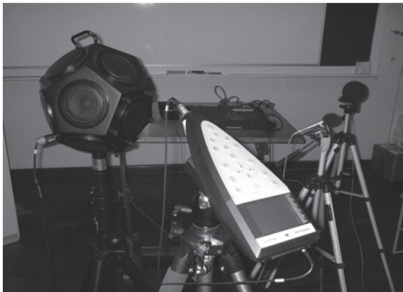
Figura 2: Sistema de Medição do Isolamento Sonoro: Analisador de dois canais BK 2260, fonte sonora dodecaédrica BK 4296, amplificador de potência BK 2716, microfones de medição BK 4190
