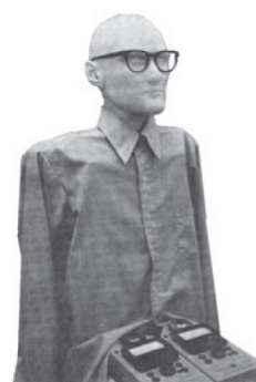
Figura 21: O manequim SAM utilizado por Conant para estudos da acústica de salas de concerto. Fonte: [22]
