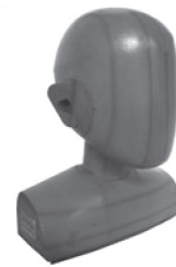
Figura 30: Manequim paramétrico para representar crianças entre 3 e 7 anos, desenvolvido no Instituto de Acústica da Universidade de Aachen, Alemanha. Fonte: foto do autor
