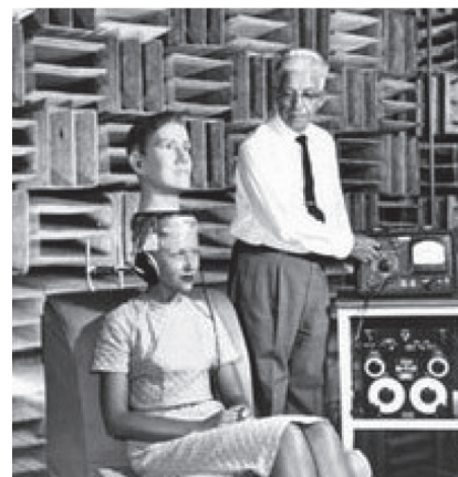
Figura 6: A cabeça artificial “Oscar II” sendo utilizada por H. Fletcher em experimentos de localização de fontes sonoras. Nesses ensaios, chamados de double dome research , uma pessoa tinha a cabeça artificial fixada à sua e escutava os sinais obtidos pelos microfones da cabeça artificial utilizando fones de ouvido. A pessoa era então requerida a apontar a direção de onde aparentemente vinha o som captado. Fonte: AT&T Corporate Archives.
