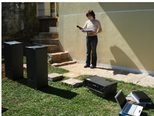
Figura 6: medição do ruído externo (EX)
