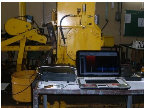
Figura 16: Fotografia do sistema de medição e análise de vibração.
