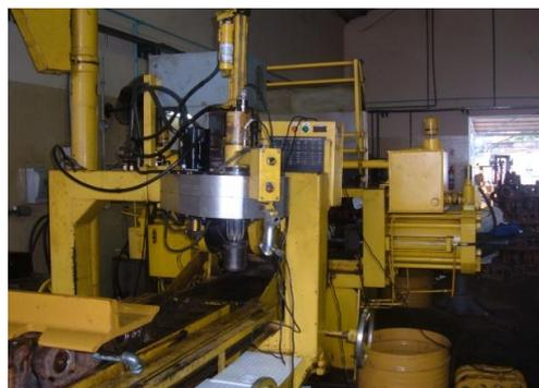
Figura 17: Vista geral da parafusadeira hidráulica montada sobre esteira.
