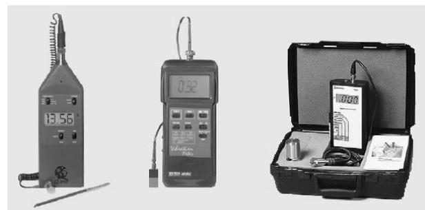
Figura 10: Medidores Portáteis de Vibração.
