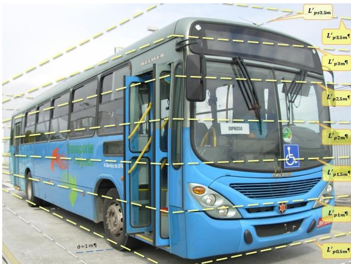
Figura 8: Representação da superfície com as linhas no entorno do ônibus nas alturas utilizadas na medição 4.
