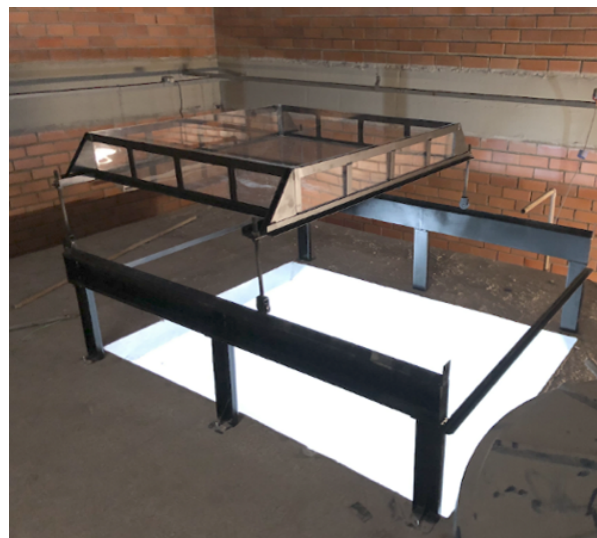
Figura 6: Estrutura para sustentação da placa perfurada de acrílico do Reservatório 1.
